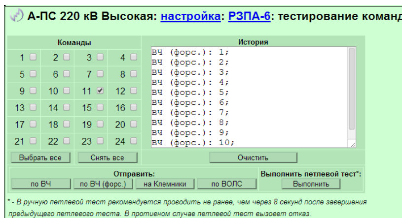
Рисунок 26 – Тестирование команд РЗ и ПА
