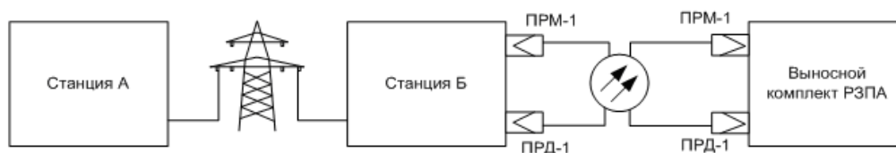
Рисунок 5 – Схема соединения основного комплекта АКСТ РЗПА «Линия-Ц» с выносным комплектом РЗПА «Линия-Ц» (функция оконечного устройства)
