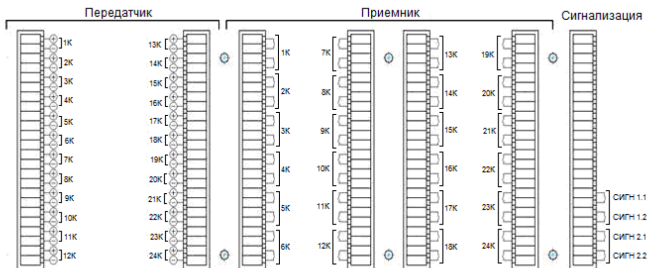
Рисунок 2 – Распределение цепей по клеммникам блока РЗПА (вид задней стороны панели)
